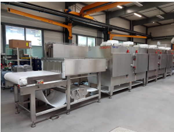
Foto 04 - Túnel de microondas SAIREM TMW 225
